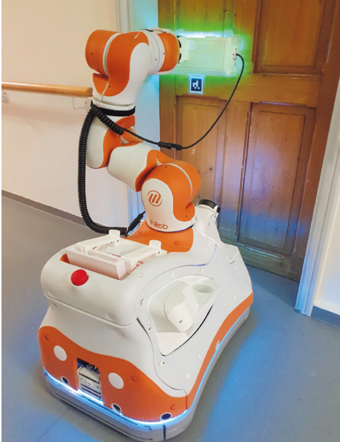
Der mobile Serviceroboter „Lio“ von F&P kann mit seinem Greifarm Getränke anreichen, Knöpfe drücken, Gegenstände holen oder bringen – oder, wie hier im Bild, Oberflächen desinfizieren.
