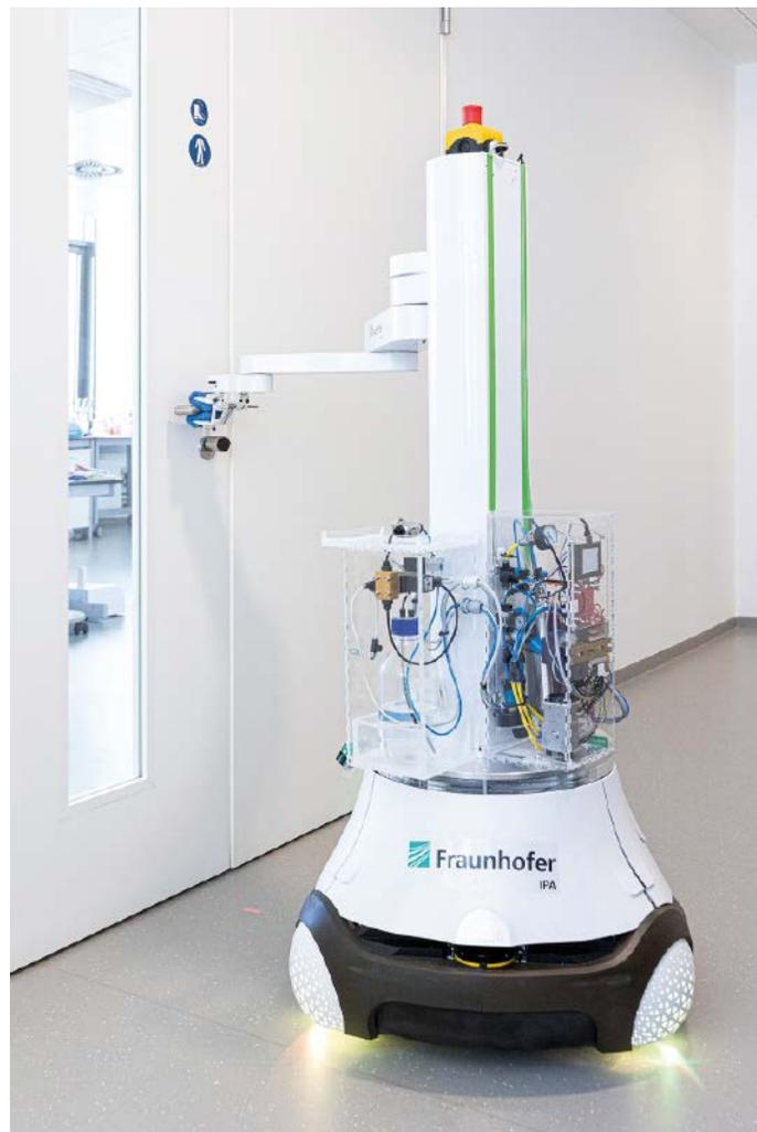
**Der mobile Reinigungs- und Desinfektionsroboter „DeKonBot“ fährt selbstständig zu kritischen Objekten wie Türgriffen und desinfiziert diese.**
