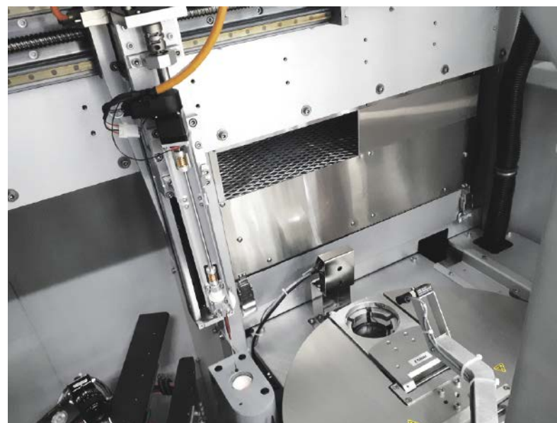
Automatisierung in der Mikrobiologie: Um möglichst gut abgegrenzte Einzelkolonien zu erhalten, erfolgt der Ausstrich des flüssigen Abstrichmediums mittels Pipetten und magnetischer Kugeln, oder aber, wie hier, mittels robotergeführter Ösen. Foto: M. Orth
