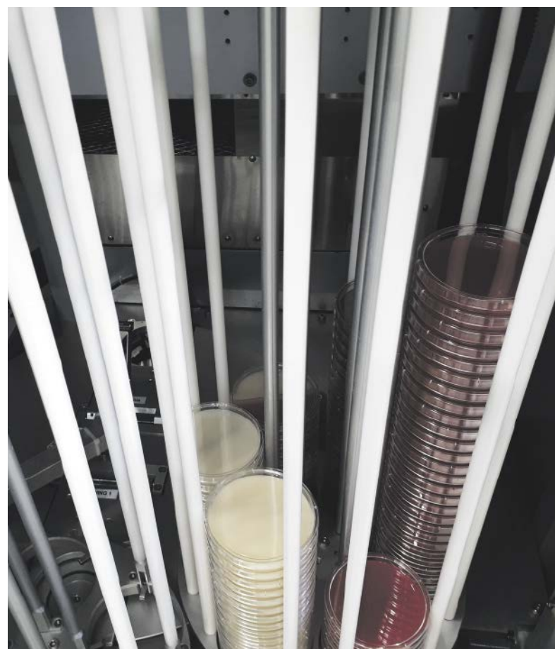
Automatisierung in der Mikrobiologie: In diesen Plattensilos werden die verschiedenen Kulturmedien für die bakteriellen Kulturen vorgehalten und mittels Greifern geöffnet und kontaminationsfrei zum Ausstreichen und anschließend wieder verschlossen zur Kultivierung transportiert. Foto: M. Orth
