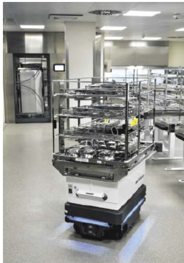
Der Roboter transportiert die rund 75 kg schweren Beladungsträger eigenständig durch die AEMP.
