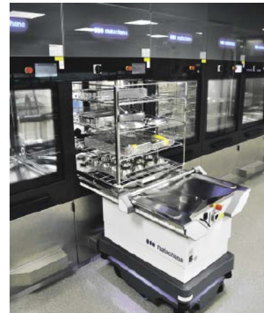
Mithilfe von RFID-Antennen erkennt die Reinigungsmaschine den nahenden Roboter und öffnet die Tür. Der AL10 schiebt den Beladungsträger in die Maschine, die daraufhin das passende Reinigungsprogramm startet.
