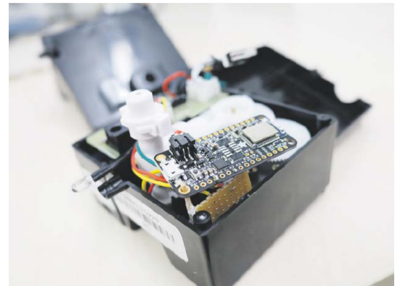
Das Innenleben des smarten Seifenspenders, der den Seifenverbrauch misst, sieht komplex aus.
