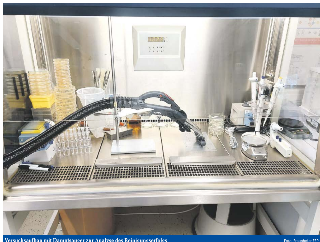
Versuchsaufbau mit Dampfsauger zur Analyse des Reinigungserfolgs
