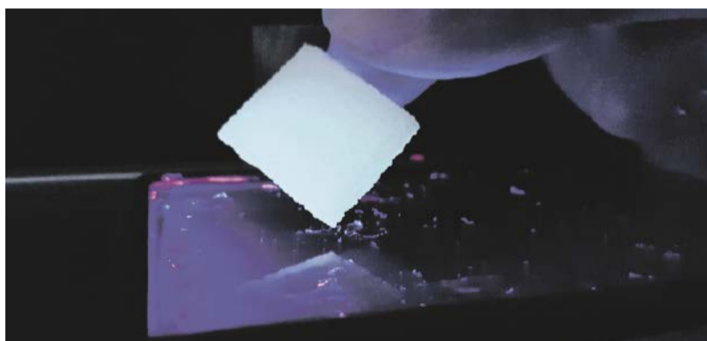
Das Kieler Pflaster kann im 3-D-Drucker passgenau hergestellt werden und wird durch grünes Licht aktiviert. Foto: Leonard Siebert
