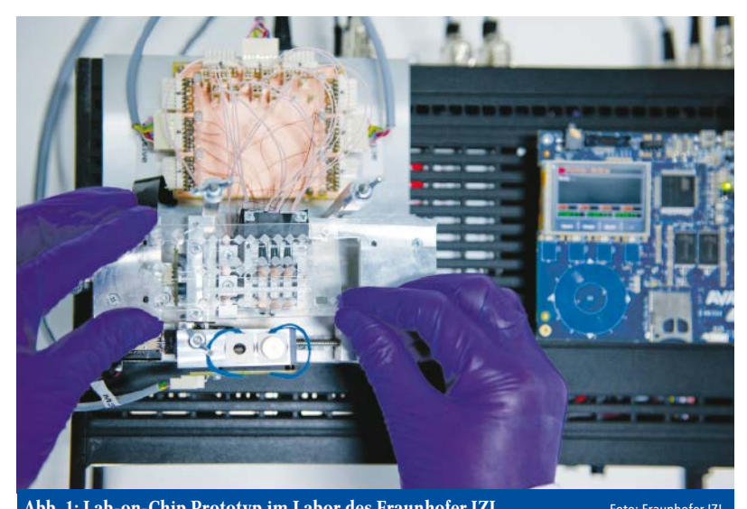
Abb. 1: Lab-on-Chip Prototyp im Labor des Fraunhofer IZI
