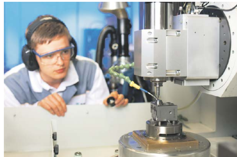
Abb. 2: Mikrozerspannung eines prototypischen Formeinsatzes für die Point-of-Care-Diagnostik
