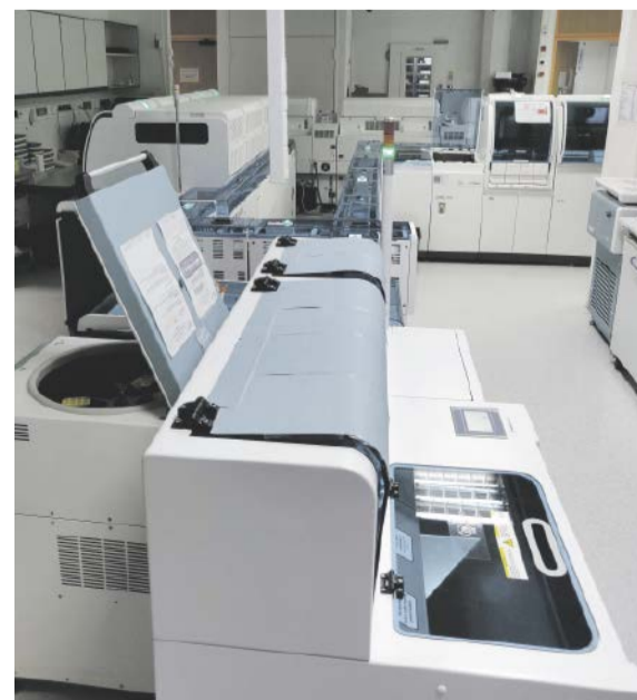
In der Laboranalysestraße verbinden Transportbänder verschiedene Messgeräte miteinander, alle Schritte laufen automatisch ab. In den vergangenen Monaten wurden neue Leitungen, neue Geräte und eine komplett neue Technik installiert.
