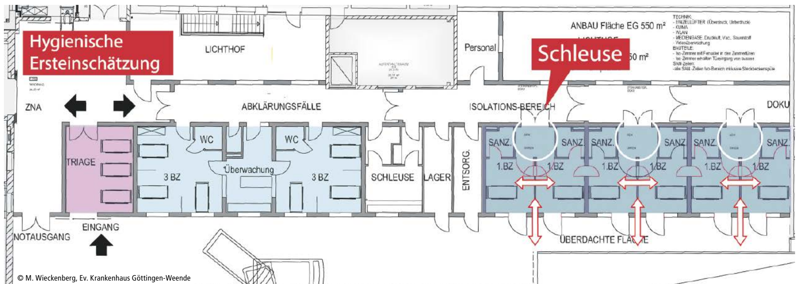
Abb. 4: Die septische Einheit der ZNA als Grundriss mit der Darstellung des Bereichs der hygienischen Ersteinschätzung, an die ein Bereich für die Behandlung von Abklärungsfällen angrenzt. Hiervon durch eine Schleuse getrennt der Isolationsbereich mit dem flexiblen Raumkonzept, bestehend aus den Basismodulen, die über Verbindungstüren miteinander verbunden sind. Darüber hinaus ist hier in jeden Raum eine Tür nach draußen integriert. ▼
