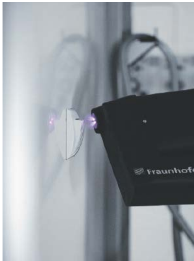
Modulare Plasmaquelle zur Reinigung und Desinfektion von Oberflächen
