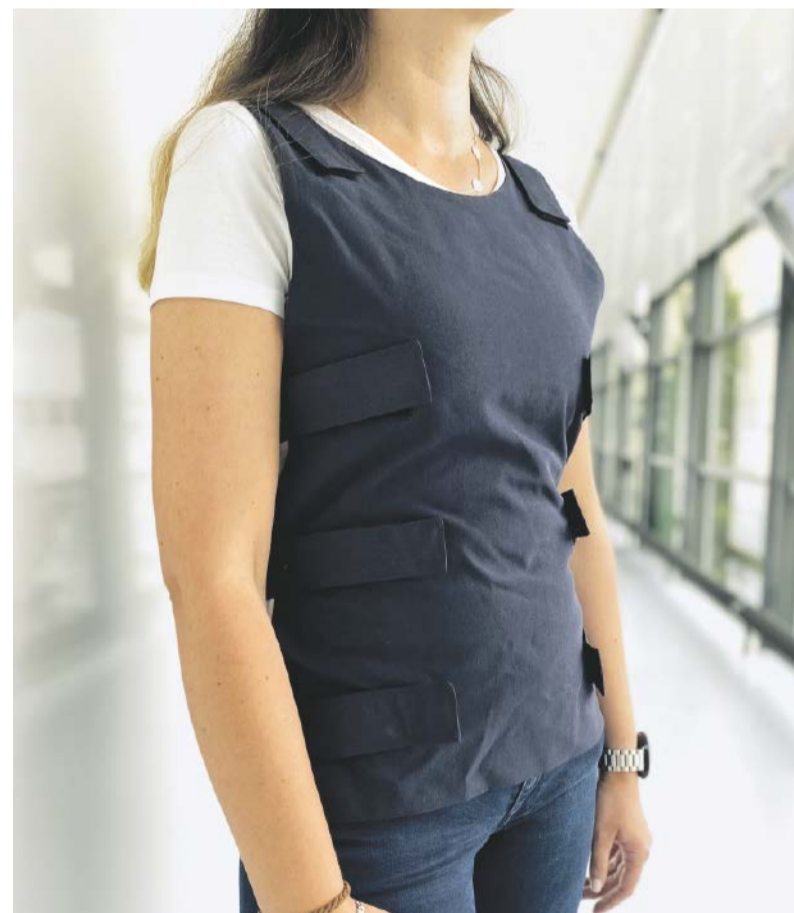
In der Vorder- und Rückseite der Textilweste sind Akustiksensoren integriert, die den Thorax abhören.
