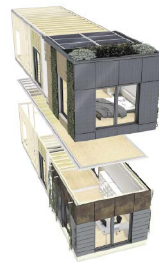
Die Hybridbauweise eignet sich für den Bau von Bettenhäusern, Funktionsbereichen, Wohnheimen und Verwaltungsgebäuden der Gebäudeklasse 4. Die schlanken zweischaligen Zwischendecken mit Installationshohlraum ermöglichen es, hohe und luftige Innenräume bei geringen Geschosshöhen zu schaffen. Foto: Alho Systembau GmbH
