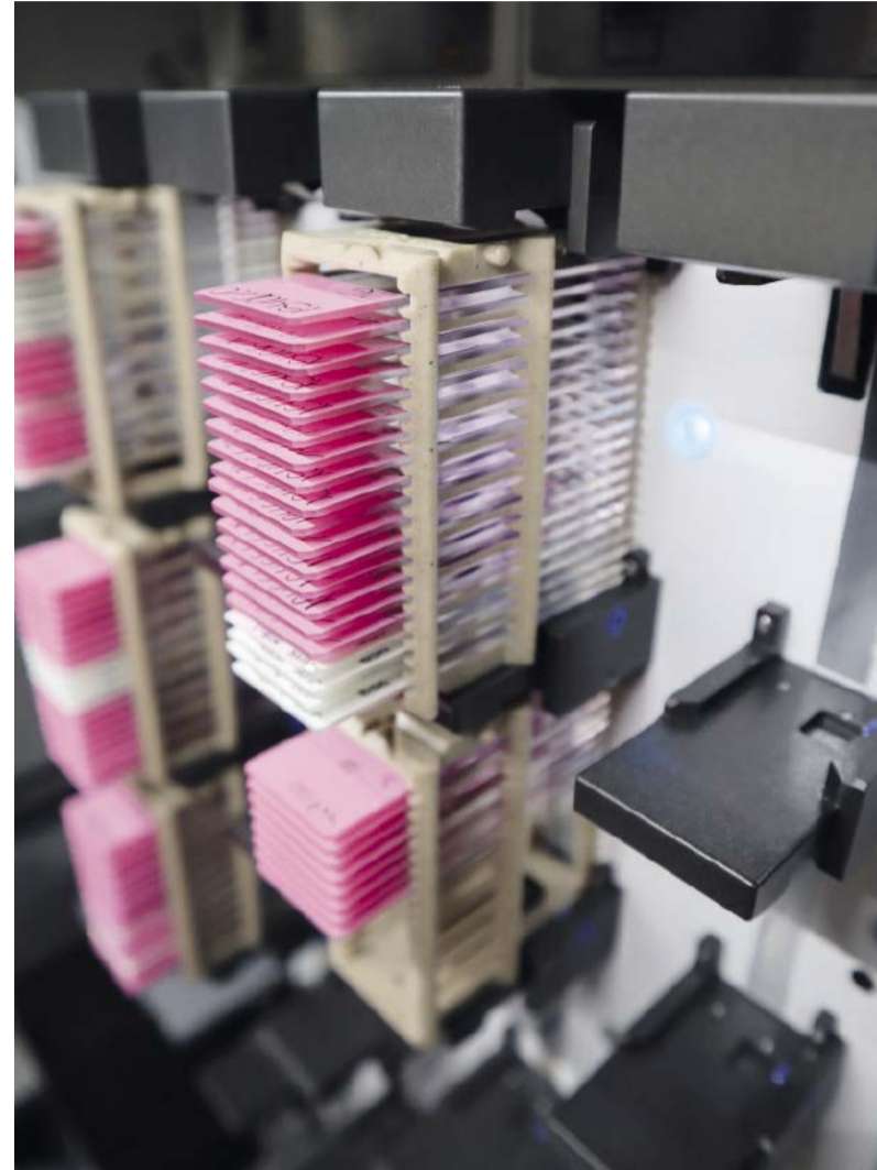
Abb. 2: Im Hochdurchsatzscanner werden Schnitte direkt nach dem Eindecken gescannt. Foto: AG Brochhausen
