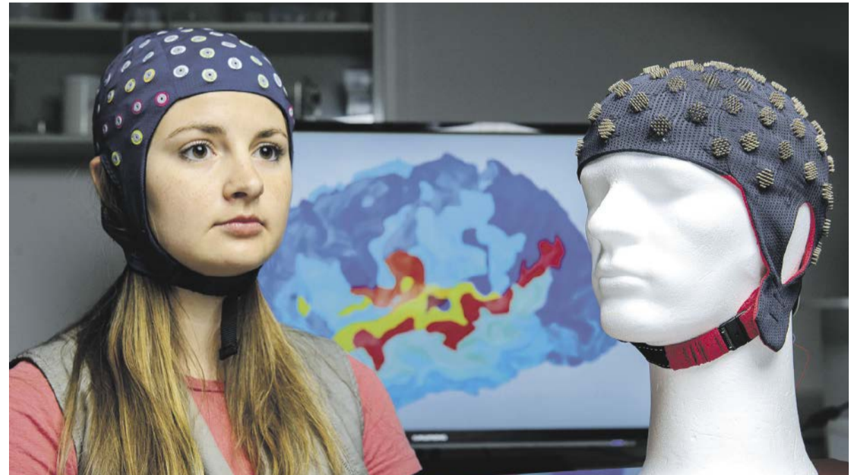
Die in Ilmenau entwickelte Haube mit trockenen Elektroden ermöglicht gleichzeitig die elektrische Messung und Stimulation des Gehirns. Foto: Susann Nürnberger
