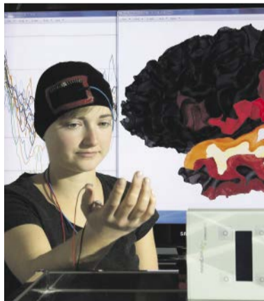
Bei der in Ilmenau entwickelten Methode werden die Hirnströme in Echtzeit gemessen und analysiert und von den gewonnenen Daten Parameter für eine elektrische Stimulation des Gehirns abgeleitet. Foto: Michael Reichel, TU Ilmenau
