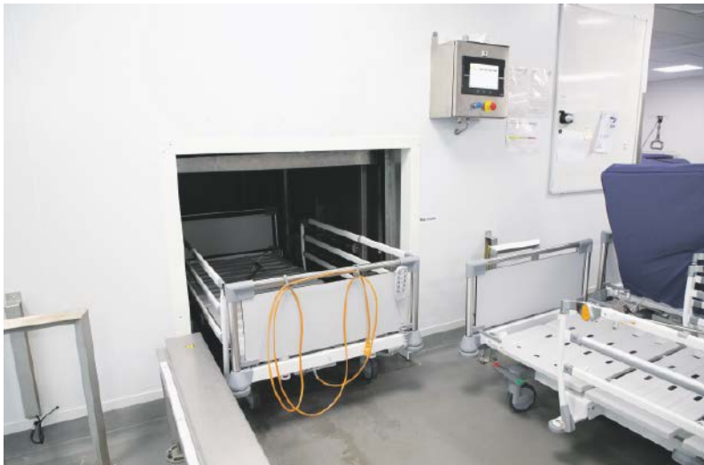
Waschtunnel für Medizinprodukte, automatisiert und schnell
