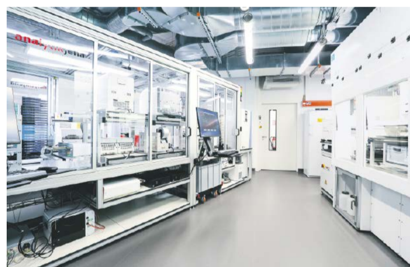
Die Robotik-Plattform führt vollautomatisch Laborarbeiten durch – von der Vorbereitung über die Durchführung bis zur Analyse eines Experiments. Dabei kann sie eine Vielzahl an Arbeitsschritten oder sogar mehrere Experimente gleichzeitig durchführen. Foto: Anna Schroll/Leibniz-HKI
