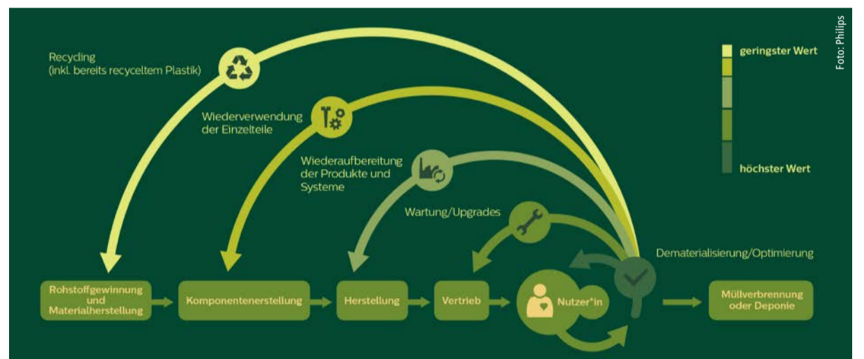
Kreislaufmodell mit fünf Rücklaufzyklen: Um den Wert von Geräten und Systemen hochzuhalten, gilt es, diese möglichst lange in den kleineren Kreisen zu halten; je besser die Langlebigkeit und Wartungsfreundlichkeit, desto geringer sind die Betriebskosten. Schließlich sind Neuschaffungen für Kliniken teurer als Instandhaltung.
