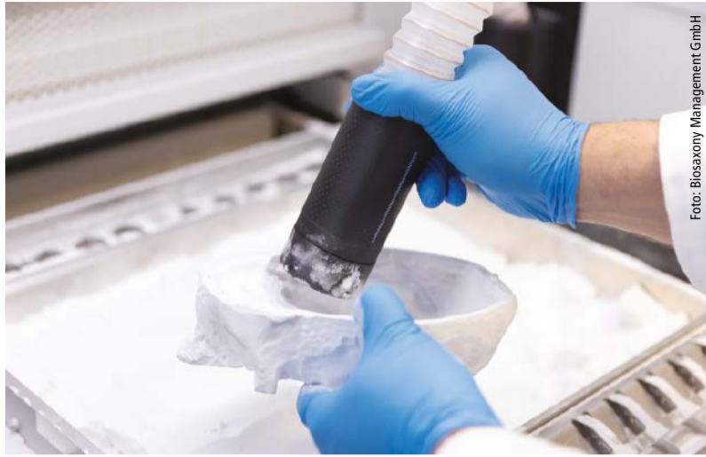
Entpulvern der PA12 3D Druckbauteile
