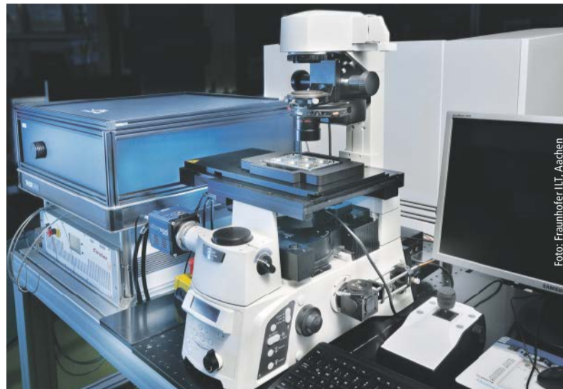
Das Liflescope vereint Hochgeschwindigkeitsmikroskopie, KI-Analyse und Lokalisation lebender Zellen und Zellverbände mit dem laserinduzierten Vorwärtstransfer (LIFT).
