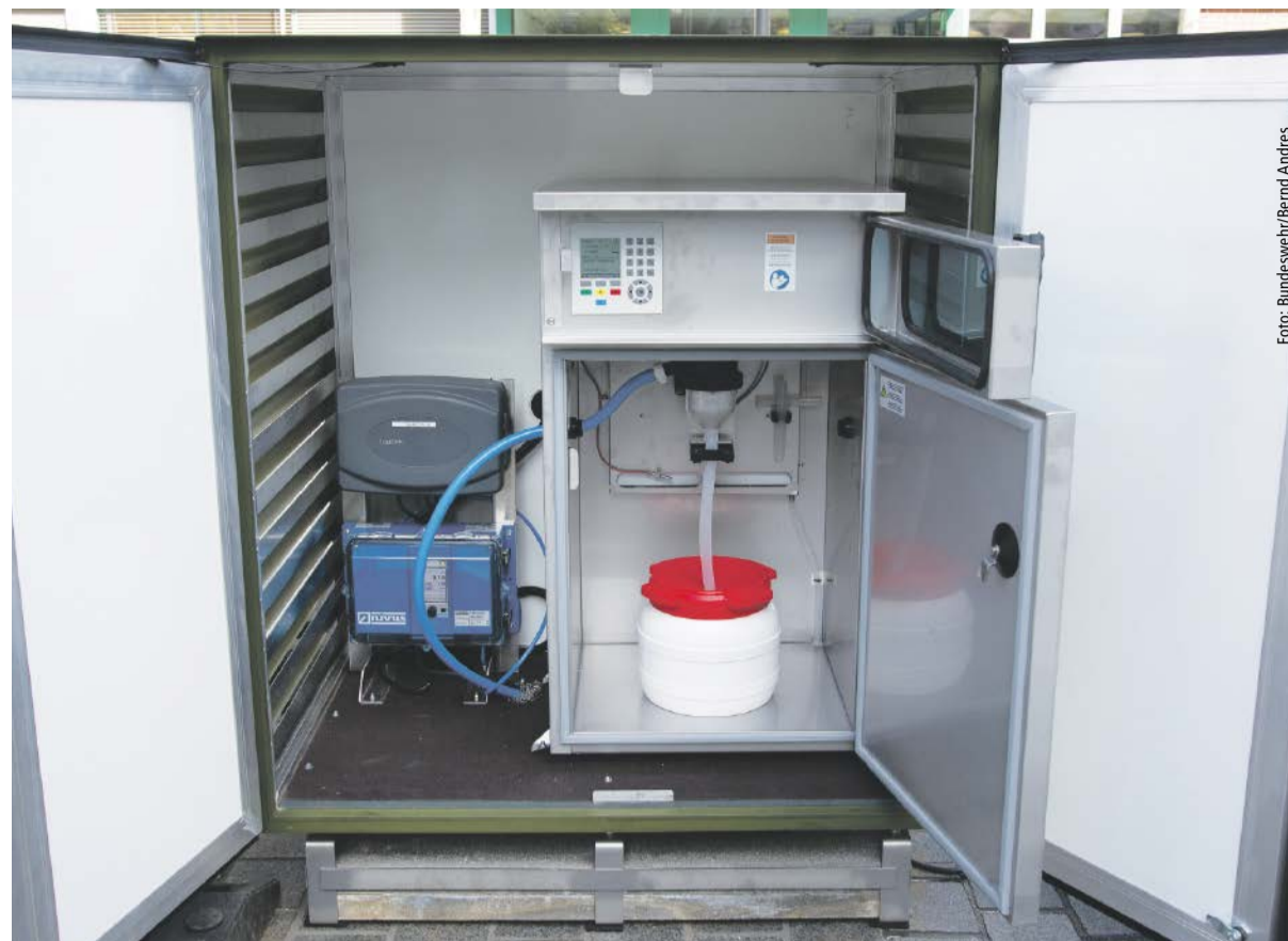
Abb. 1: Innenansicht der Probenentnahmestelle. Vollautomatisierter Probennehmer zur Abnahme einer sog. 24h-Mischprobe (rechts) einschließlich Messsonde zur exakten Bestimmung von Fließmenge- und -geschwindigkeit (links im Gehäuse).
