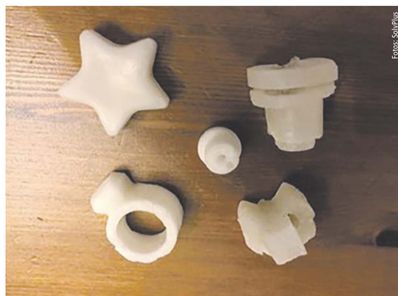
Beispiele für Festkörper aus reiner Hyaluronsäure, die die Härte von Beton haben, sich aber in wässriger Umgebung kontrolliert auflösen.
