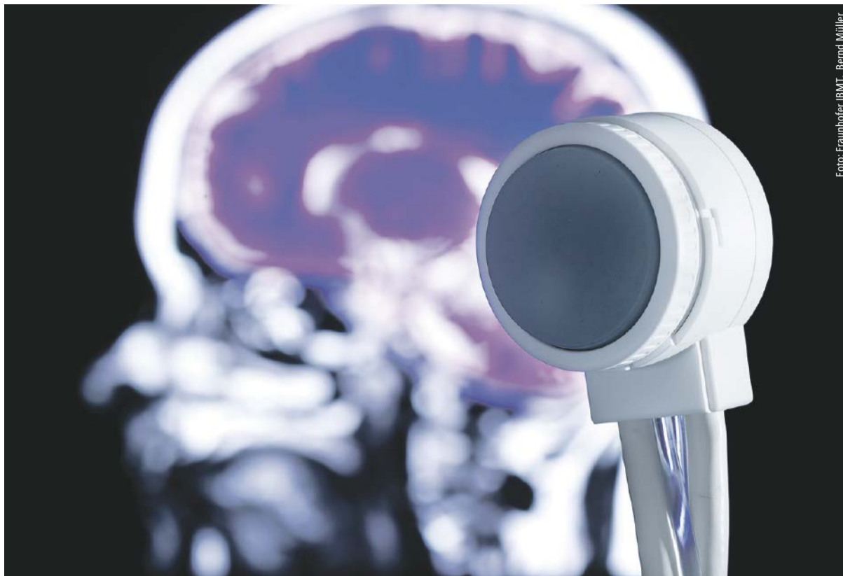
Der 3D-Matrix-Ultraschalltransducer für die transkranielle Neurostimulation ist in der Lage, exakt bestimmte Punkte in der Tiefe des Gehirns zu stimulieren.
