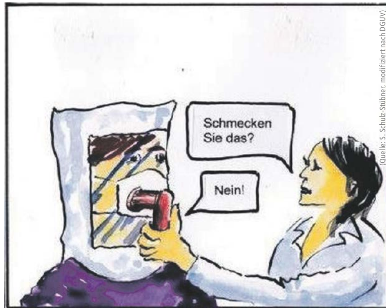
Schematische Darstellung des Fit-Testing zur Dichtigkeitsprüfung der Maske bei aerogener Verbreitung von Pathogenen
