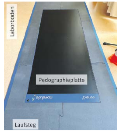
Abb. 1: Pedographieplatte emed-xl mit portablem Laufsteg (Fa. Novel)
